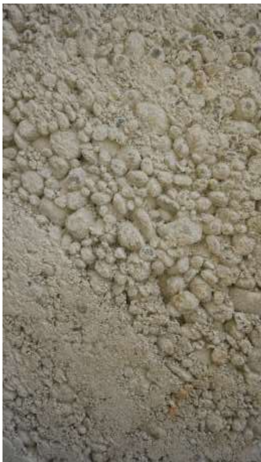
Stampfbeton mit Weißzement Landesgartenschau Öhringen 2016
